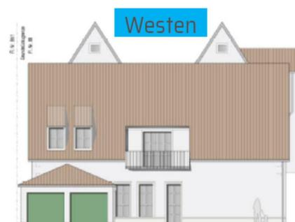
Für die neue Nutzung werden laut Bauantrag im Erdgeschoss für eine bessere Belichtung der Tagespflege die vorhandenen Fenster bis zum Fußboden vergrößert und auch neue Fensterflächen eingebaut.
